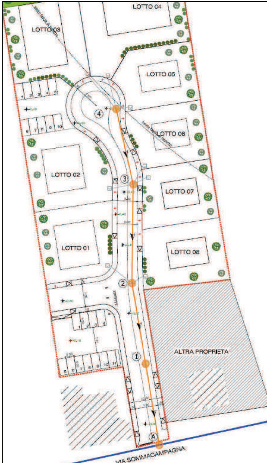
Figura 4: Disegno in pianta delle future lottizzazioni con indicati i tratti di fognatura nera.
